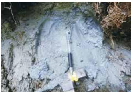
写真2 風化によって粘土化した玄武岩質緑色岩
