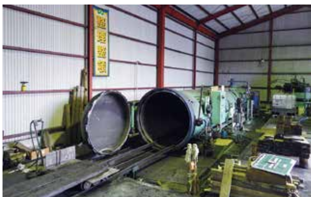
加压注入機械
