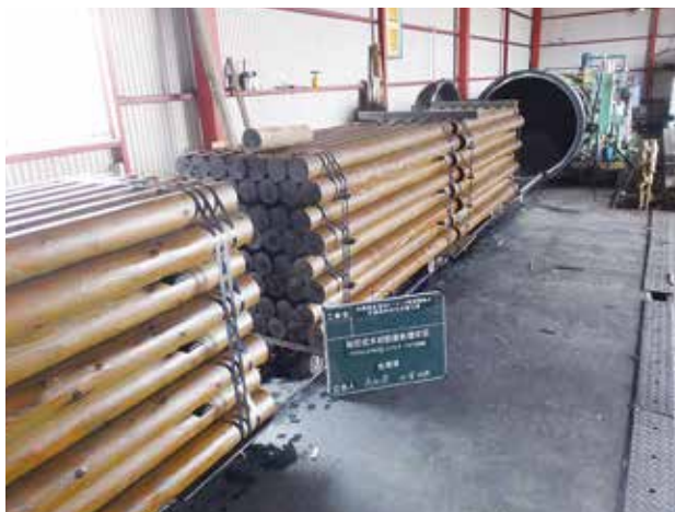
(木製ダム 加圧注入処理)
