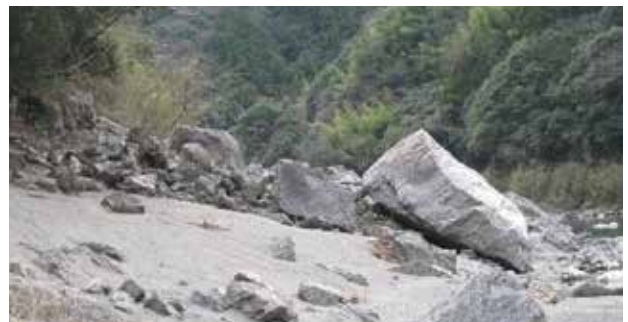
写真3 崩落発生斜面对岸に見られるチャートの巨石残骸 (角ばっていて、近隣からもたらされたことを示す)
