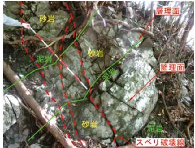
写真3 受け盤構造の砂岩泥岩互層内に生じた割れ目
