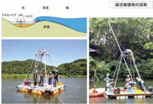
図2. 津波堆積物の形成プロセス(上左)、土佐市蟹が池の津波堆積物調査(下左)および大分県佐伯市竜神池の調査風景(右)。
