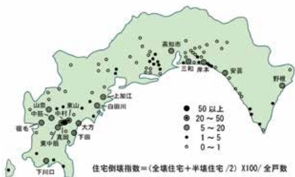
図2 昭和南海地震 (M8.0) による高知県下の建物の倒壊率 (金井ほか、1947)
