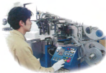
コンデンサ用セパレータの試作テスト Capacitor Separator Winding Test
