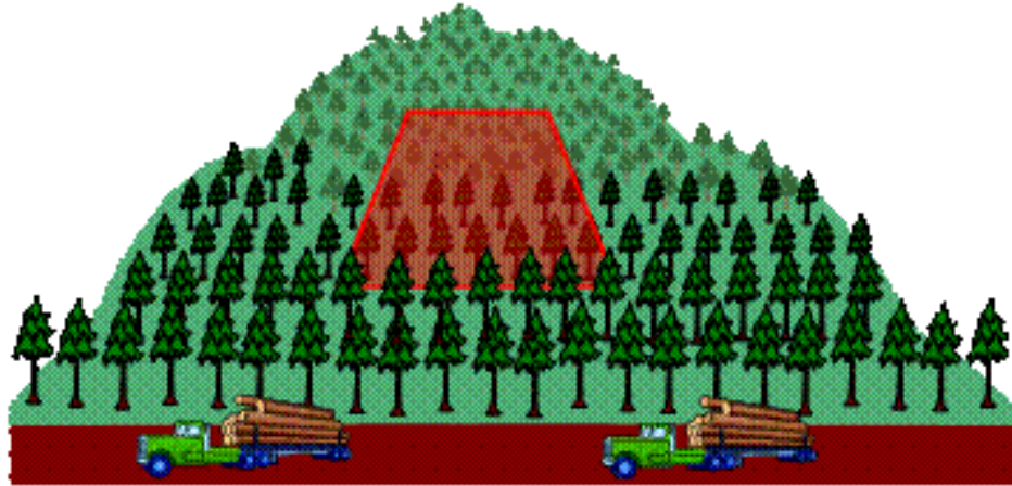
図 II-5 プロジェクト対象地に傾斜がある場合のモニタリングプロット設定方法
