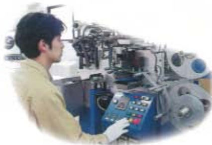
コンデンサ用セパレータの試作テスト Capacitor Separator Winding Test
